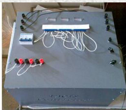
Mostra instalației de reglare a decalajului de fază cu puterea de 3kW
